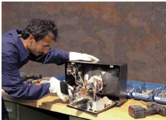
Manuelle Demontage eines Fernsehgerätes
