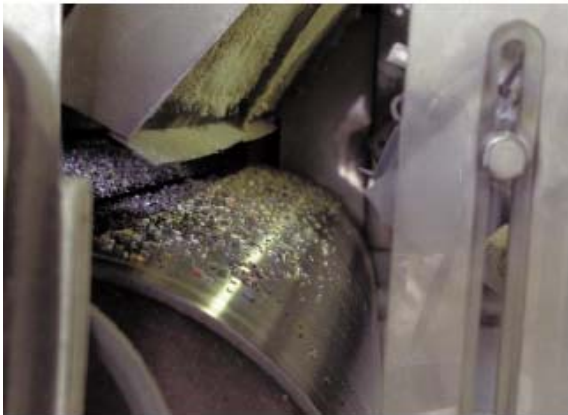
Detail eines Corona Walzenscheiders
