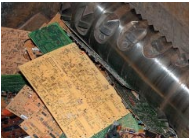
Vorzerkleinerung von Leiterplatten
