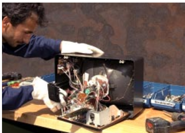
Manuelle Demontage und Schadstoffentfrachtung
