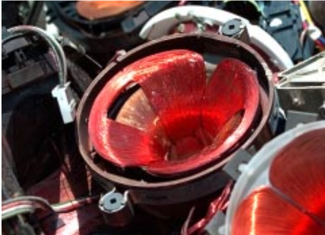
Unterschiedliche Ablenkspulen, wie sie von Demontagebetrieben angeliefert werden
