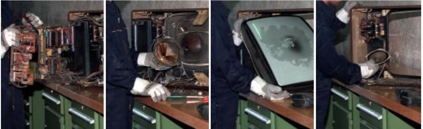
Darstellung der einzelnen Arbeitsschritte bei der Demontage von Fernsehgeräten Ausbau des Elektrochassis / Abdrehen der Ablenkeinheit von der Bildröhre / Ausbau der Bildröhre / Ausbau der Lautsprecher
