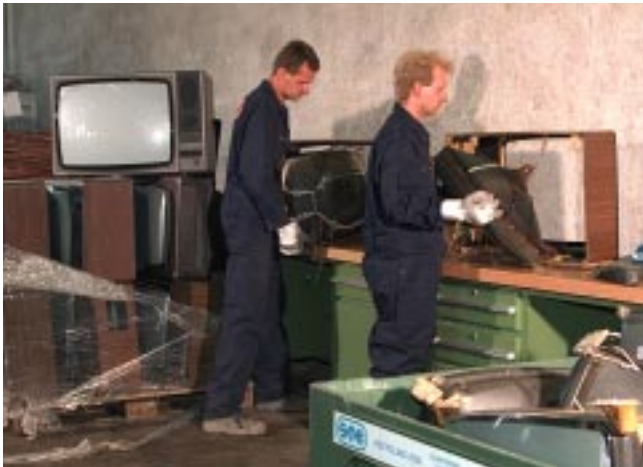
Manuelle Demontage und Schadstoffentfrachtung bei Fernsehgeräten
